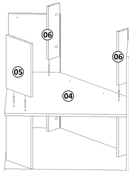
1 - Fixar o tampo nº02 lateral direita nº01 e a lateral esquerda nº02 , nas travessas da dobradiças nº06 e no apoio traseiro nº05 com parafuso c (5,0x45).
