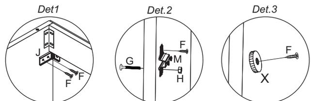
Utilizar os Parafusos (G) e as Porcas (H) nos furos dos Calços (M).
