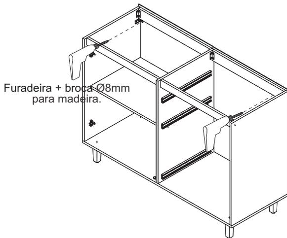
**12** Posicionar e nivelar o balcão no local de uso e marcar a parede através dos furos.
