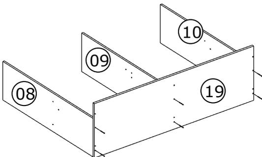
1 - FIXAR A LATERAL ESQUERDA DA TORRE Nº08, A LATERAL DIREITA DA TORRE Nº09 E A LATERAL DIREITA AÉREO Nº10 NO TAMPO DO BALCÃO Nº19 COM PARAFUSO "A" (5,0x50).
