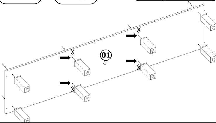
1 - Fixar os calços para dobradiça K com parafuso D (M4x20) a porca E (M4) e o parafuso A (3,5x14).
