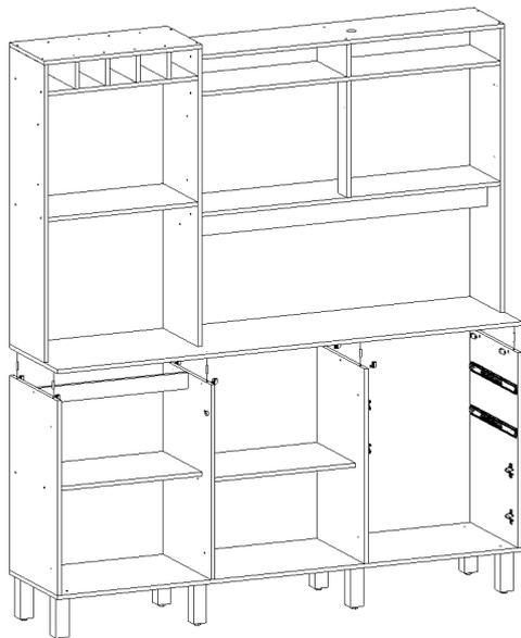
1 - Fixar os calços para dobradiça K com parafuso D (M4x20) a porca E (M4) e o parafuso A (3,5x14).
