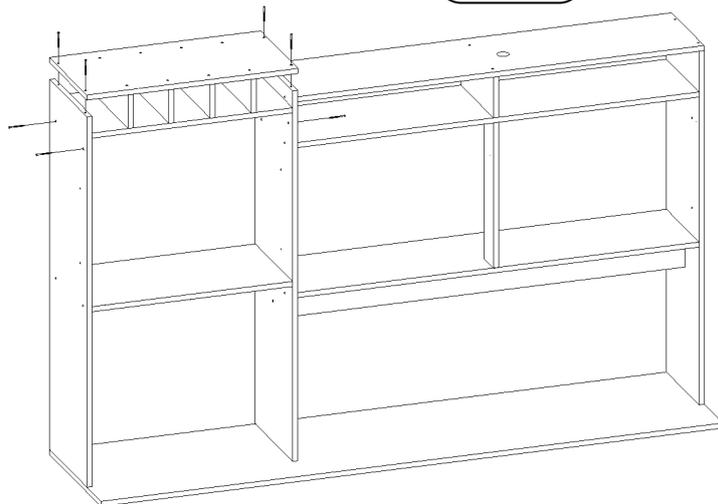
1 - Fixar a parte superior já montada no balcão com cavilhas P, dispositivo trapézio N e parafuso C (3,5x25).
