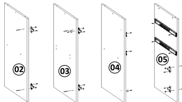
1 - Fixar a lateral direita nº05, a lateral esquerda nº02, a divisória direita nº04, a divisória esquerda nº03 na base nº01 com parafuso B (5,0x45).
