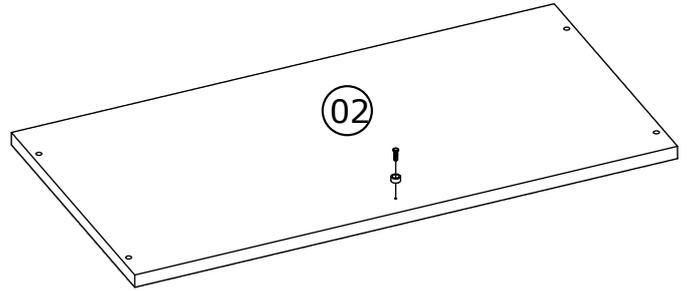
1 - FIXAR O BATENTE "M" NO TAMPO DA TORRE Nº02 COM PARAFUSO "C" (3,5x14).
