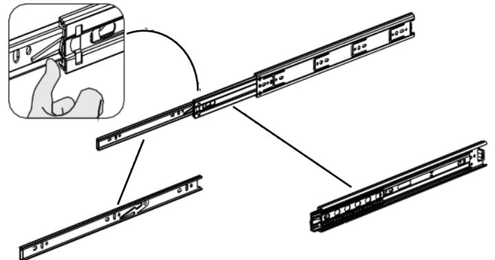
1 - Fixar as corredeiras S na Lateral Esquerda 03 com o parafuso A (3,5X14).
