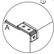
**12** Caso deseje fazer a união entre módulos utilize os parafusos (E). Utilizar as capas para suporte (J) para acabamento.
