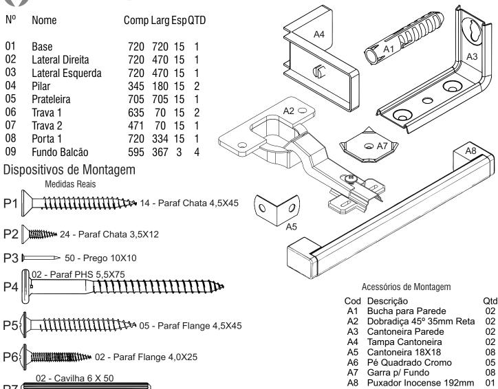
Fixação na parede: Furar a parede com maquinário adequado. Fazendo as marcações de pontos antecipadamente. Usar broca de parede para bucha10, instale a bucha no furo da parede. (A profundidade do furo não deve exceder 75mm). Passe o parafuso P7 através da cantoneira metálica direcionado ao centro da bucha, e em seguida parafuse. Repita o processo nas 2 cantoneiras.
